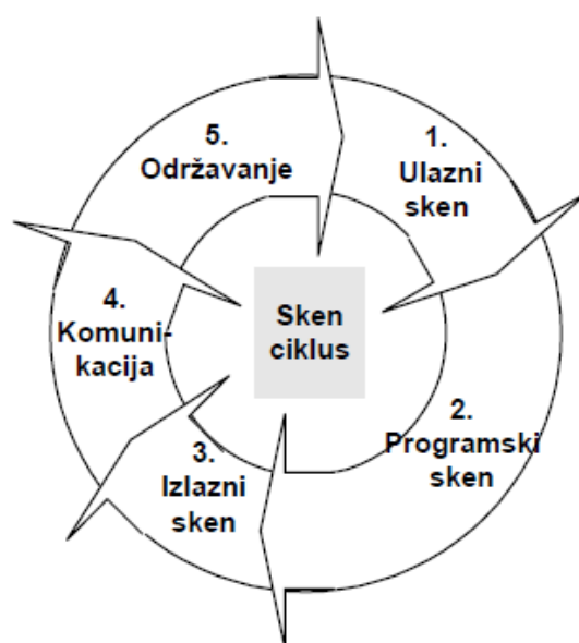
Sl. 4-10 Sken ciklus PLC kontrolera.
